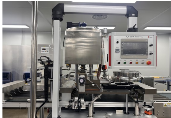
· Hot Pouring Filling Machine
